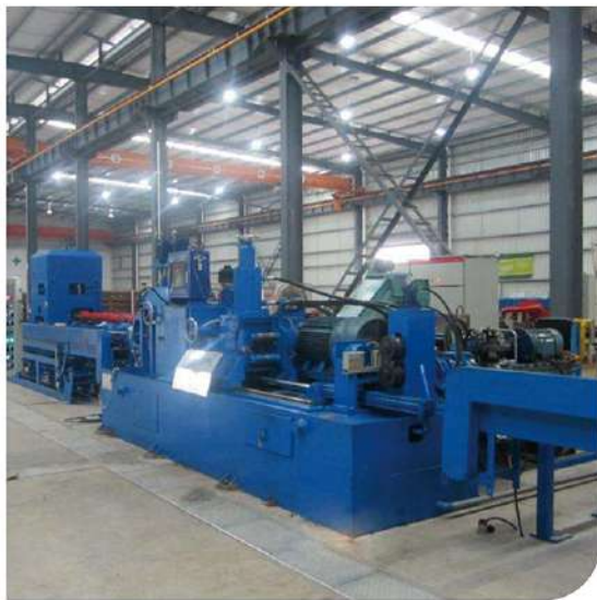
圆钢剥皮机 ROUND BAR PEELING MACHINE
