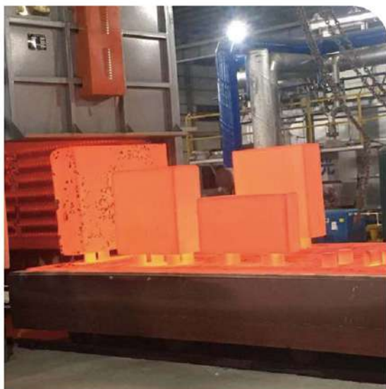
台车式调质生产线 TROLLEY-TYPE QT LINE
